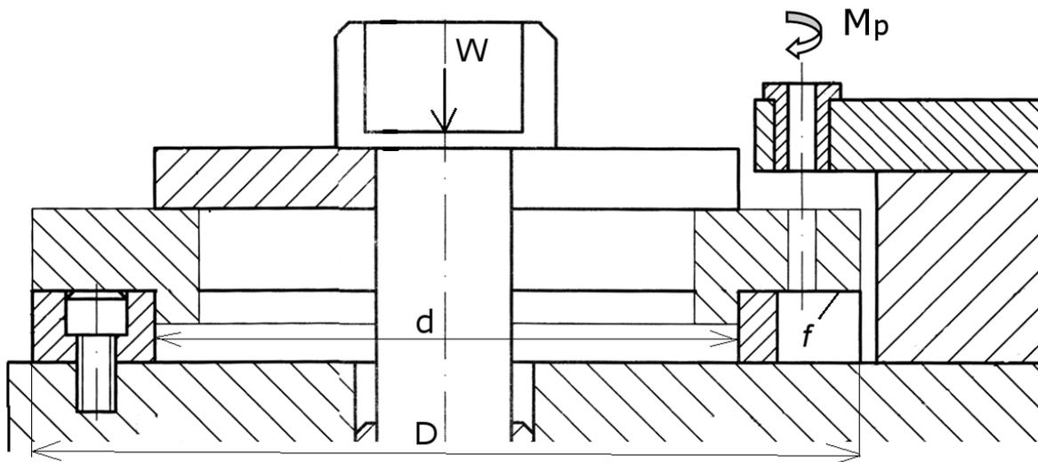
Рисунок 8.4 – Схема для расчета силы закрепления заготовки-штулки при сверлении отверстия через кондукторную втулку
