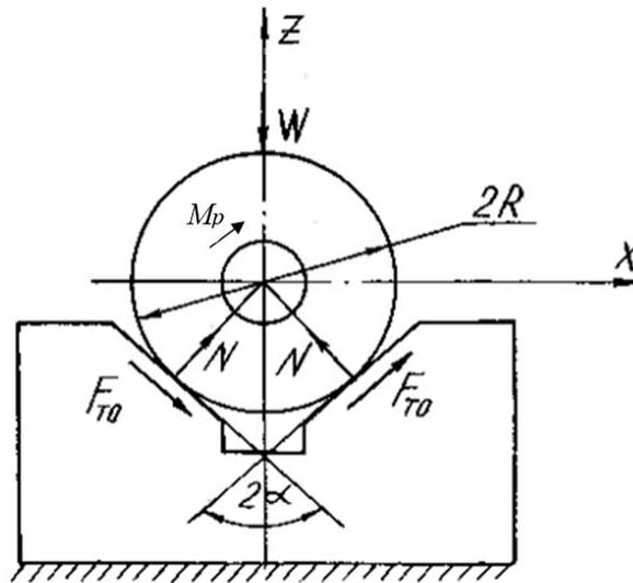
Рисунок 8.1 – Расчетная схема сил закрепления цилиндрической заготовки-втулки
