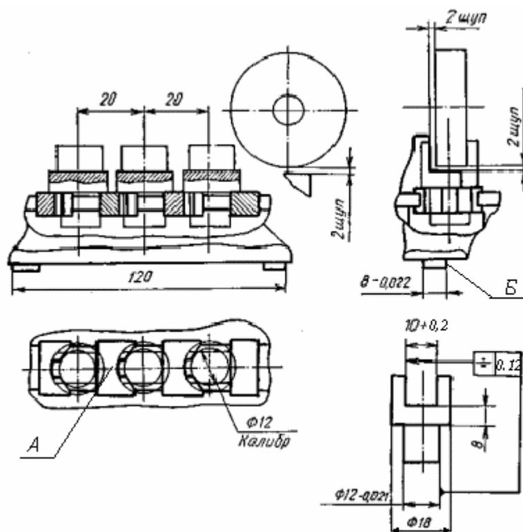
Рисунок 11.1 – Многоместное фрезерное приспособление для обработки пазов
