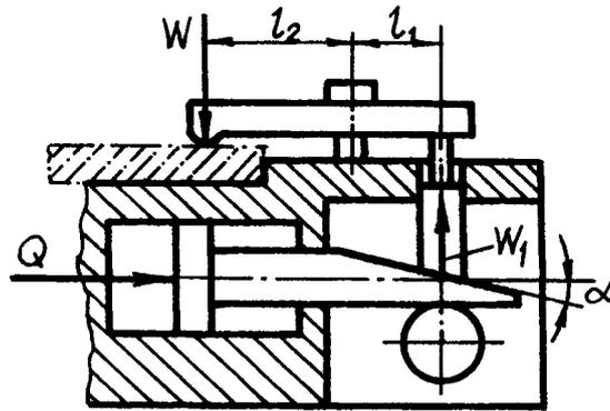
Рисунок 8.7 – Схема приспособления с комбинированным зажимным механизмом
