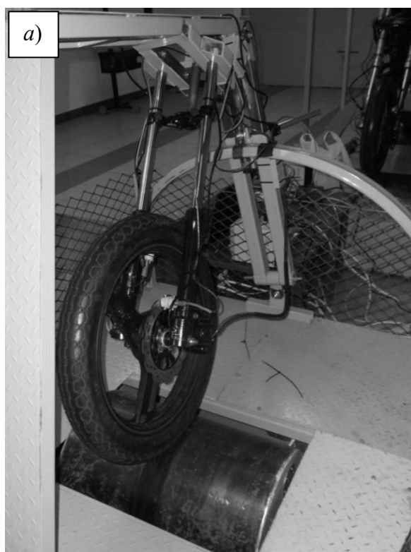
Рис. 4. Тормозной роликовый стенд с установленными гидравлической и механической тормозными системами на колесо мотоцикла: а – роликовый стенд с установленной гидравлической тормозной системой; б – роликовый стенд с установленной механической тормозной системой
