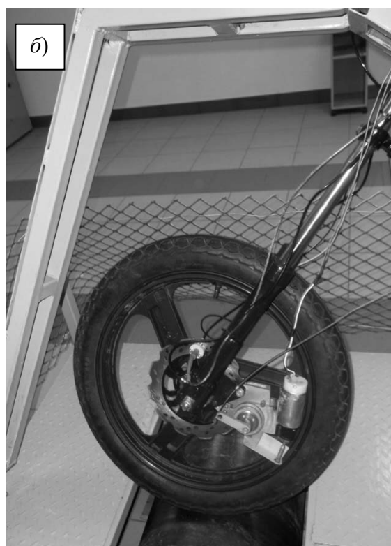
Рис. 4. Тормозной роликовый стенд с установленными гидравлической и механической тормозными системами на колесо мотоцикла: а – роликовый стенд с установленной гидравлической тормозной системой; б – роликовый стенд с установленной механической тормозной системой
