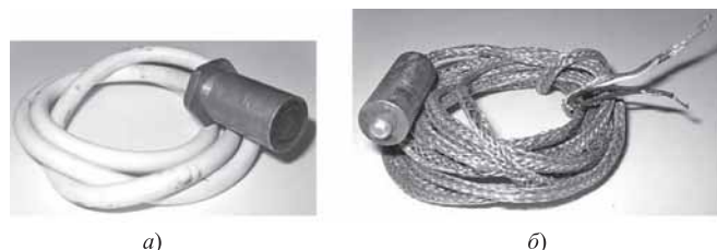
Рис. 3. Индукционные датчики измерения реализуемых колесами тормозных моментов и их производных по времени:
