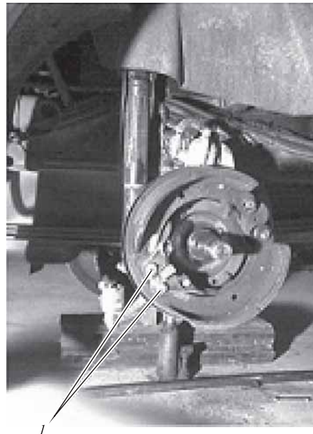
Рис. 5. Поворотные оси колодок барабанного тормоза автомобиля МАЗ-544018-320-030, включающие датчиками измерения тормозного момента (силы) в контакте колес с опорной поверхностью:
