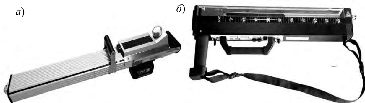
Рис. 1. Устройства для измерения сопротивления сверления древесины: IML-Resi PD 400 ( https://www.iml.de/ ) и Resistograph R650 ( http://rinntech.de/ )
