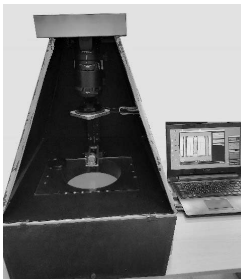
Рис. 1. Установка для контроля распределения напряжений в тонкостенных стеклянных контейнерах
