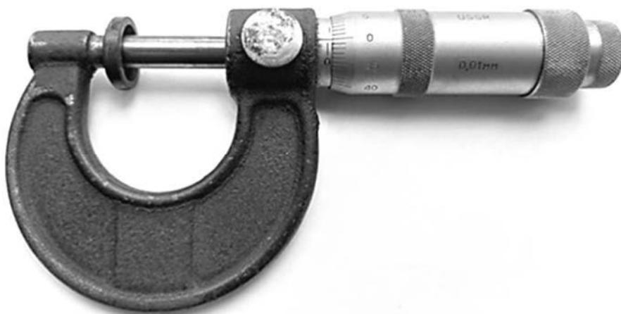
Рис. 6. Измерение толщины керамического протектора микрометром типа МК
