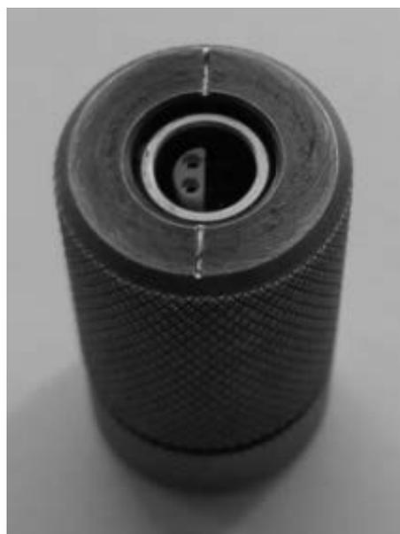
Рис. 3. Расположение ВТП ПН-12-МДФ01 в защитном корпусе
