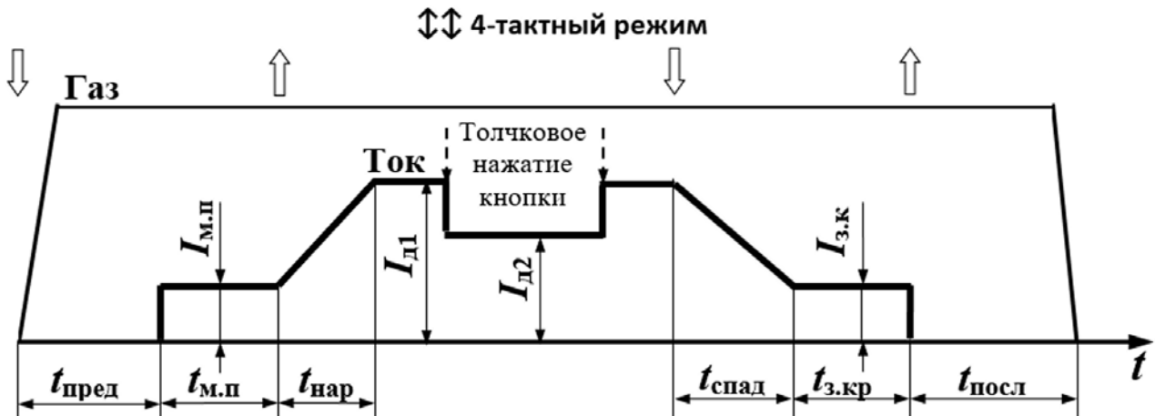
Рисунок 5.4 – Четырехтактный цикл аргонодуговой сварки
