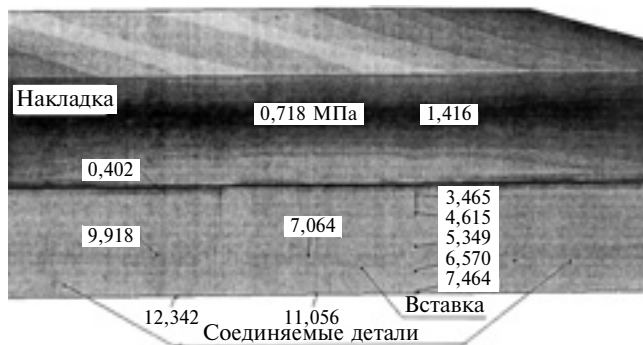
Рис. 7. Распределение рабочих напряжений в паяном соединении со вставкой
