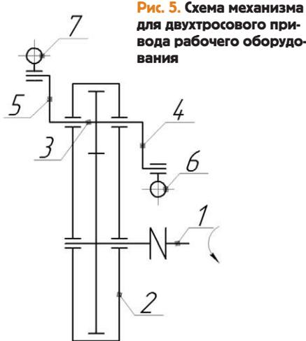
**Рис. 5.** Схема механизма для двухтросового привода рабочего оборудования
