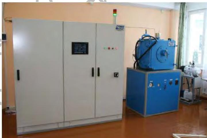
Рис. 1. Универсальная полупромышленная установка ионного азотирования дверного типа
