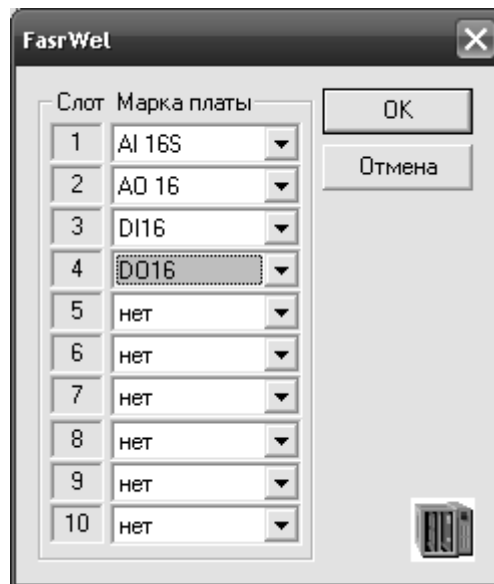
Рисунок 5.8 – Настройка процедуры автопостроения базы каналов
