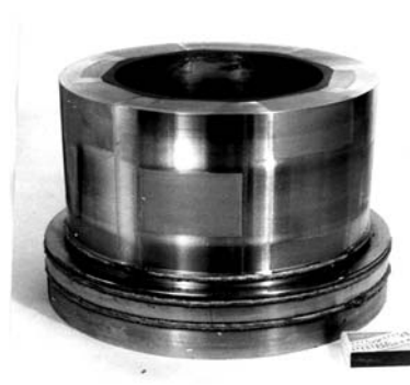
Рис. 5. Биметаллические роторы, изготовленные с применением электронно-лучевой сварки: а – из стали 13X12H2M2BФАБ (ЭП517) и сплава ХН36ТЗБЗКЗЮ2 (ВУС-17); б – из стали 02X12К12Д2 (ДИ48) и сплава ХН40МТЮБР (ДИ49)
