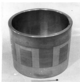
Рис. 5. Биметаллические роторы, изготовленные с применением электронно-лучевой сварки: а – из стали 13X12H2M2BФАБ (ЭП517) и сплава ХН36ТЗБЗКЗЮ2 (ВУС-17); б – из стали 02X12К12Д2 (ДИ48) и сплава ХН40МТЮБР (ДИ49)
