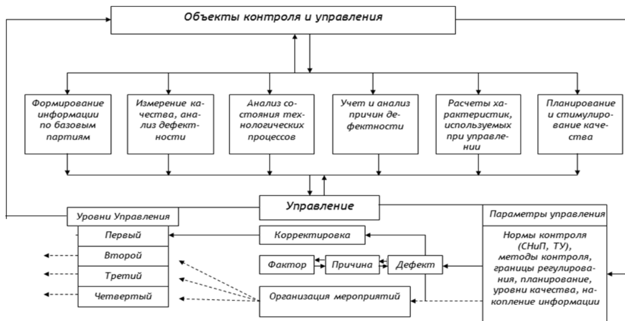
Рис. 1. Четырехуровневая система управления качеством сварочных работ
