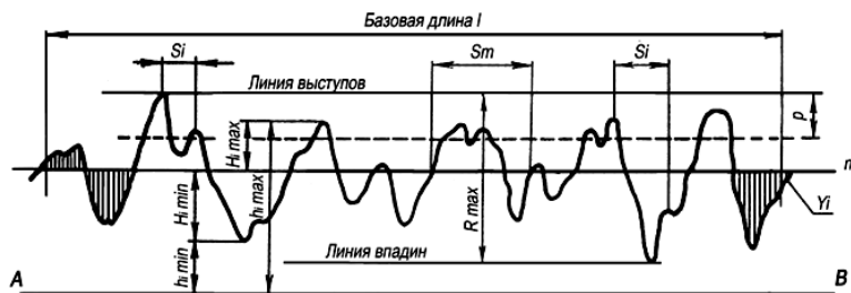
Рисунок 22.1 – Обобщенный микрорельеф обработанной поверхности
