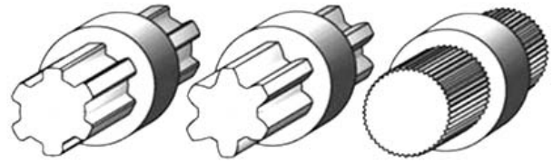
Рисунок 19.2 – Профиль зубьев шлицевого соединения
