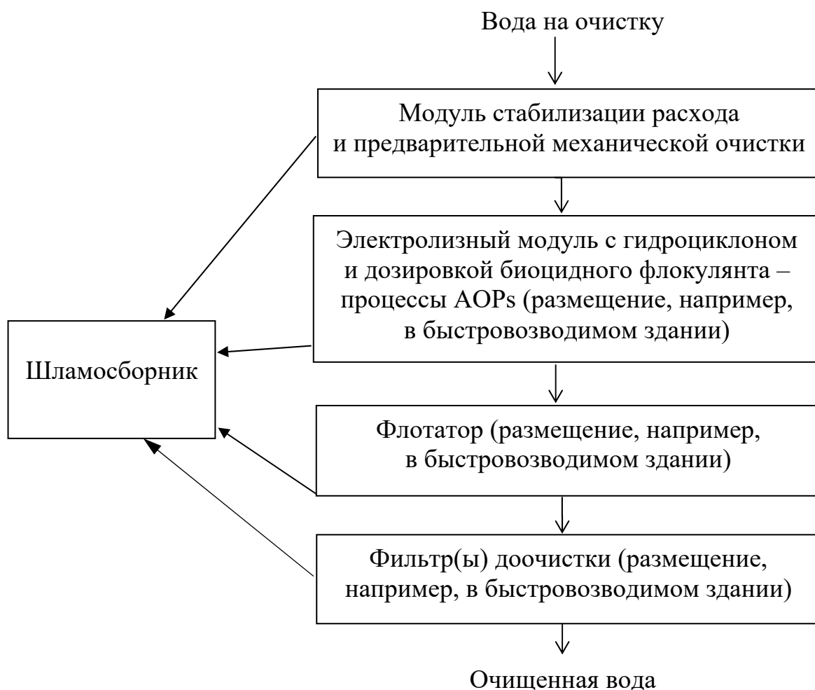
Рис. 3. Усовершенствованная схема локальных сооружений очистки сточных вод пищевых предприятий
