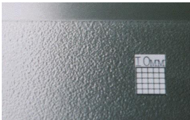
Рисунок 2 – Рельеф поверхности после ПВДО
