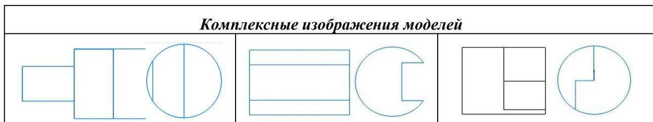
**Рисунок 3 – Комплексные изображения геометрических тел цилиндрической формы**
