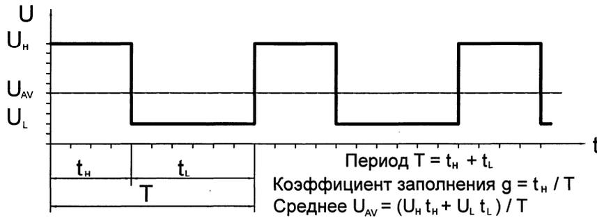
Рисунок 1.2 – Определение периода  $T$ , коэффициента заполнения  $g$  и среднего арифметического  $U_{AV}$  прямоугольных импульсов напряжения  $U$
