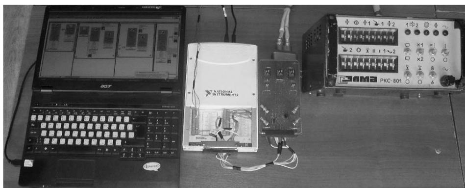
Рисунок 3.2 – Аппаратура активного контроля энергии тепловложения в межэлектродную зону в процессе контактной точечной и рельефной сварки
