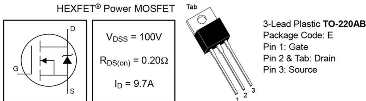
Рисунок 4.3 – Расположение выводов и характеристики *n*-канального MOSFET-транзистора типа IRF520N в корпусе TO-220AB
