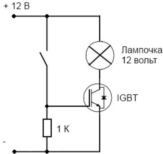
Рисунок 4.4 – Схема проверки IGBT транзистора
