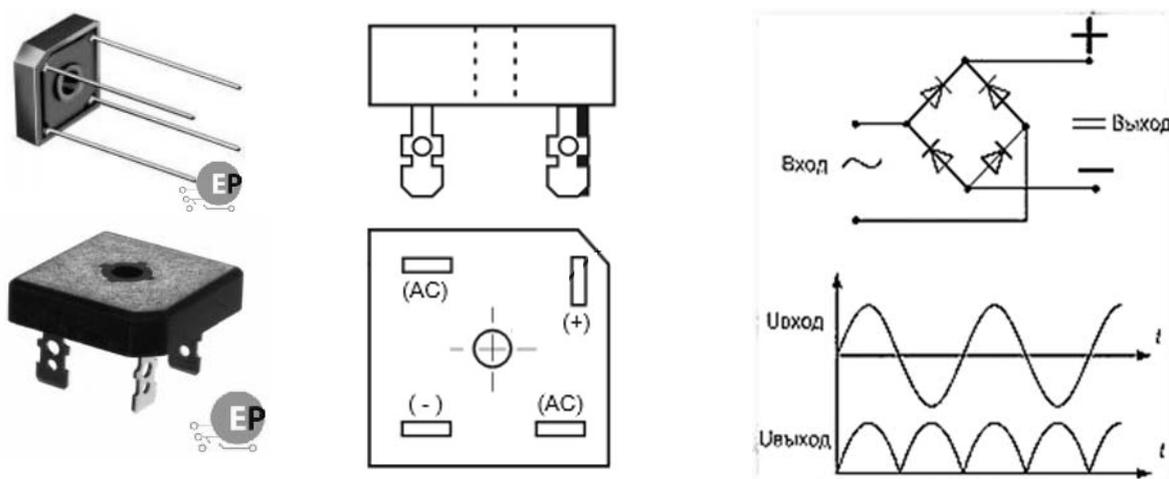
Рисунок 3.2 – Выпрямительный диодный мост GBPC3508W
