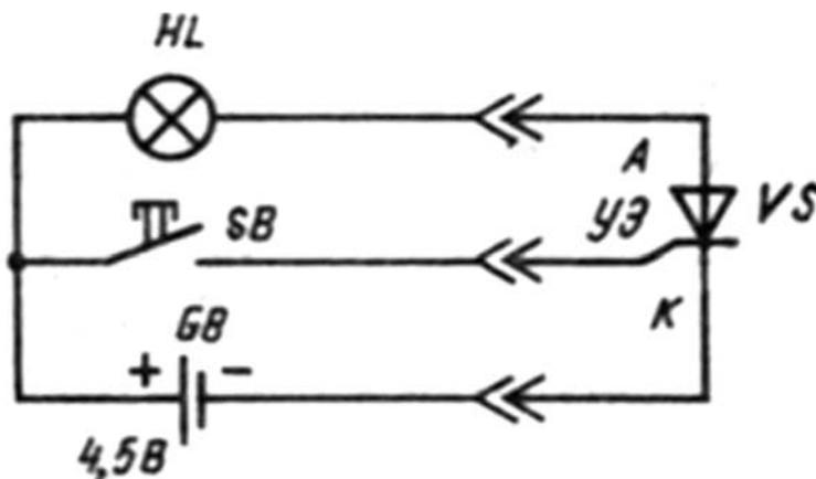
Рисунок 3.3 – Проверка работоспособности тиристорov
