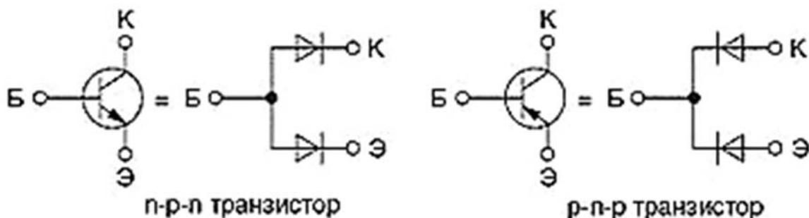
Рисунок 4.1 – Проверка исправности биполярных транзисторов
