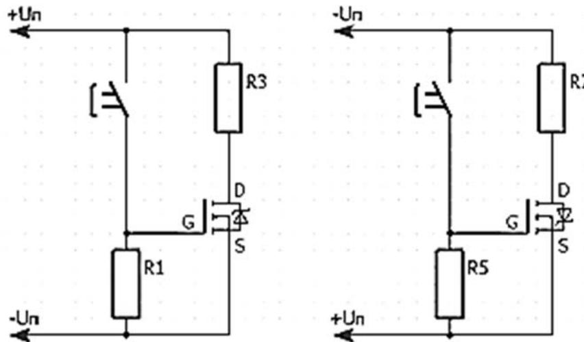
Рисунок 4.5 – Схема проверки  $n$ - (а) и  $p$ -канального (б) MOSFET-транзисторов
