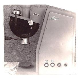
Рис. 5. Общий вид пружинной мельницы
