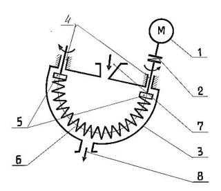
Рис. 4. Кинематическая схема пружинной мельницы
