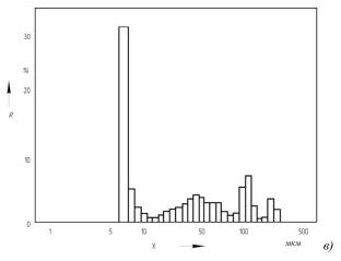
Рис. 6. Гранулометрические составы дисульфида молибдена
