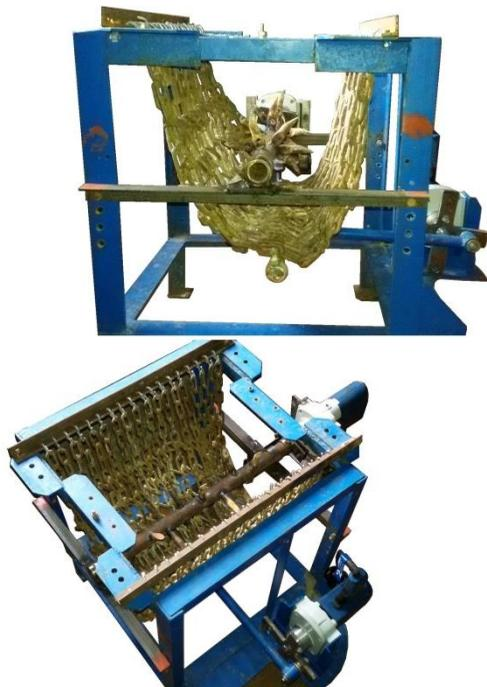
Рисунок 2 – Экспериментальная установка с цепным рабочим оборудованием
