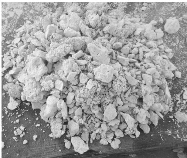
Рис. 7. Состав материала после измельчения в цепном агрегате
