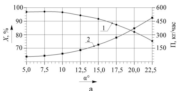
Рис. 3. Влияние угла установки  $\alpha^\circ$  рабочей камеры на эффективность работы процессы волнового аппарата
