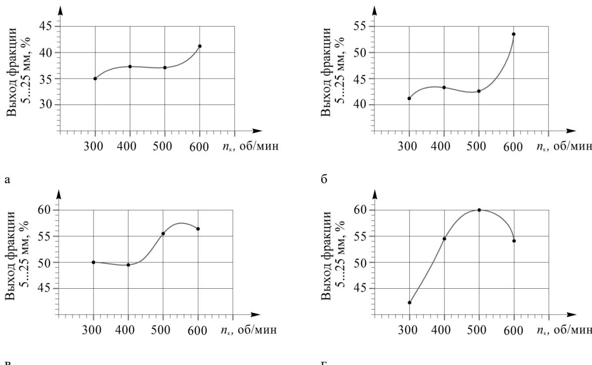
Рис. 6. Влияние частоты вращения  $n_k$  и длины кривошипа  $r$  на процесс измельчения мела
