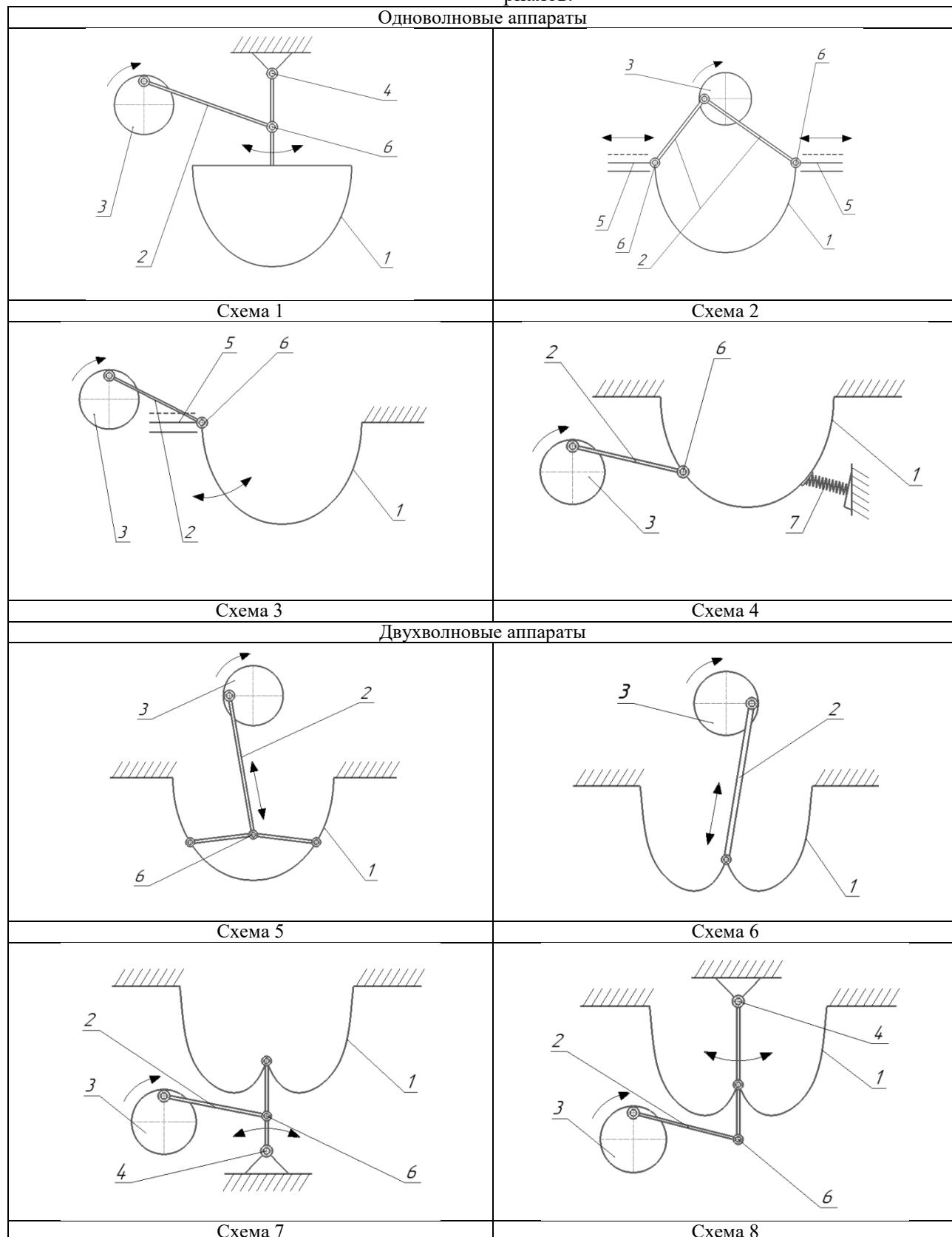
Рис. 1. Кинематические схемы волновых аппаратов
