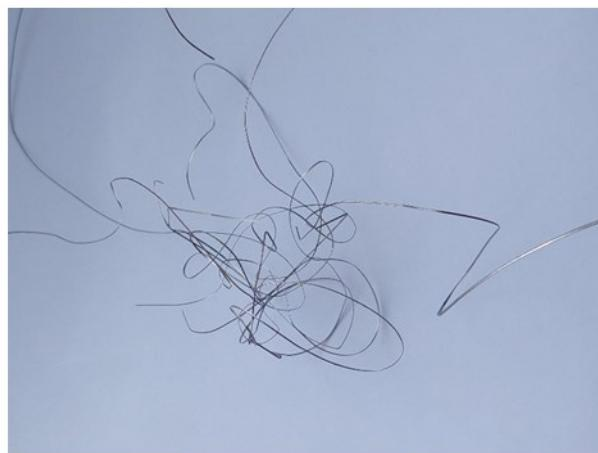
Рис. 5. Металлическая губка с фрагментом микроволокна
