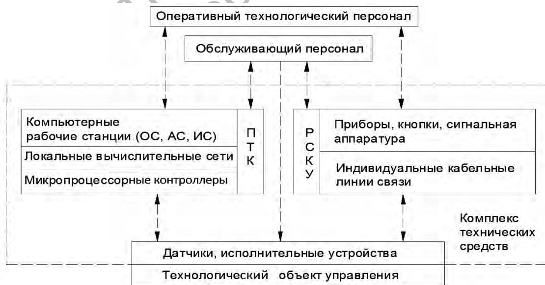
Рис. 1. Общая структура АСУ ТП ПГУ: ОС – операторская станция; АС – архивная станция; ИС – инженерная станция; ПТК – программно-технический комплекс; РСКУ – резервные средства контроля и управления
