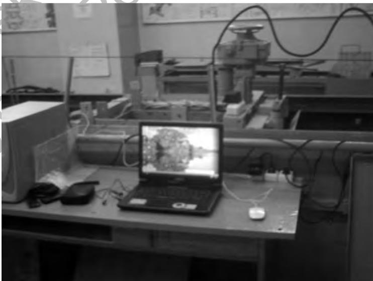
Рис. 5. Тензометрическая тележка с компьютером
