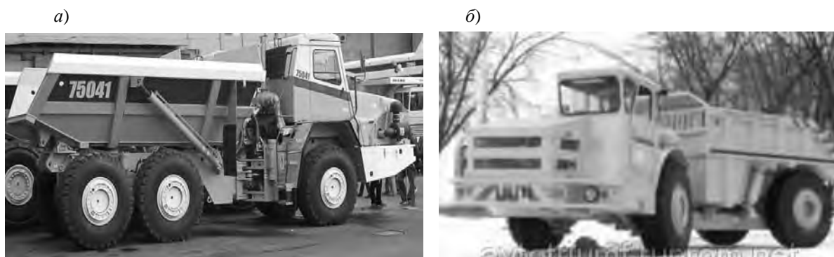
Рис. 3. Землевозы и подземная техника Могилевского завода им. С. М. Кирова: а – самосвал-землевоз МоА3-75041 грузоподъемностью 27 т; б – самосвал шахтный МоА3-74052-9586 грузоподъемностью 25 т
