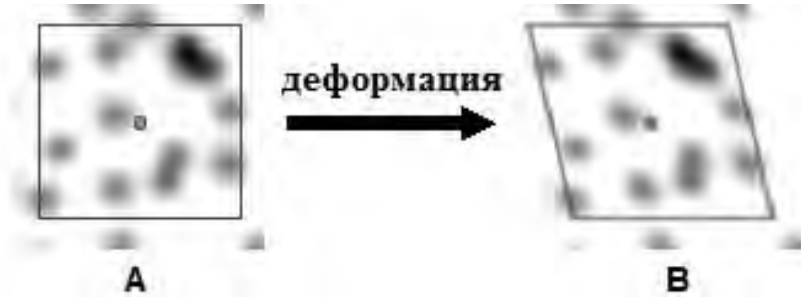
Рис. 2. Определение перемещения участка в деформированном изображении
