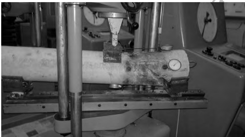
Рис. 1. Колонна круглого сечения после проведения испытаний
