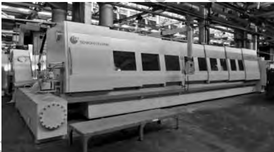
Рис. 6. Станок модели ML700-1-10000 немецкой фирмы «ТБТ Тифбортехник»
