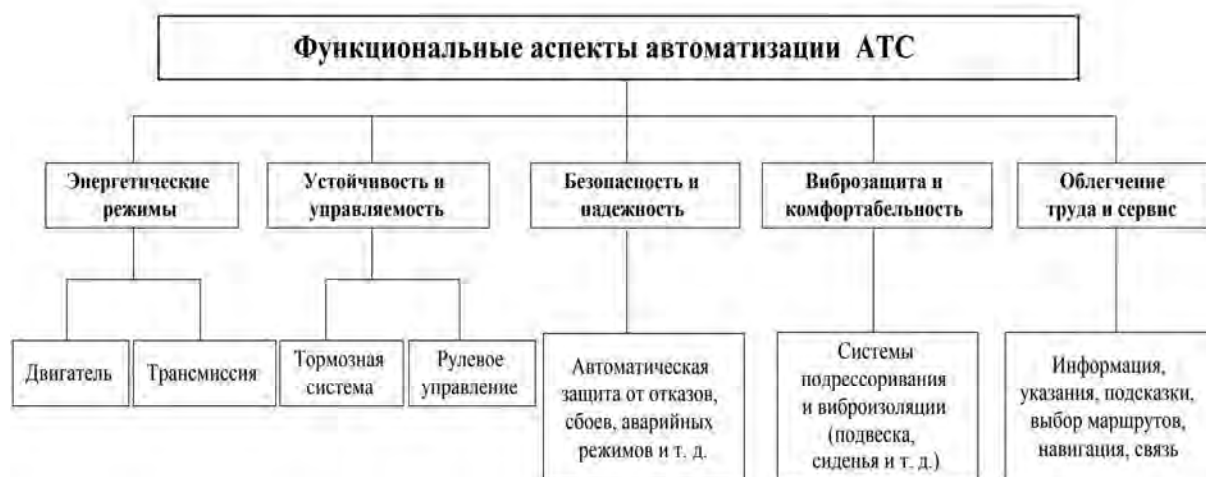
Рис. 1. Функциональная схема видов автоматизации мобильной машины как технического объекта
