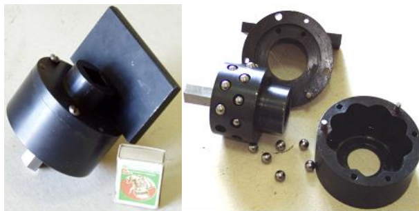
Рис.4. Фотография общего вида и деталей усилителя момента к машинным тискам
