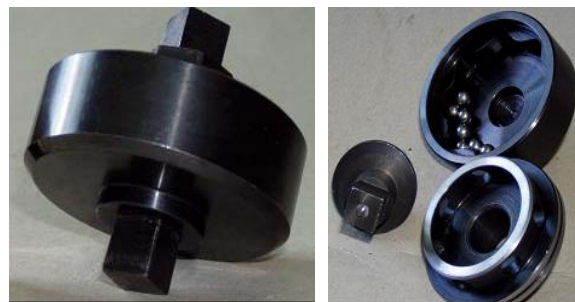
Рис.5. Фотография общего вида и деталей усилителя момента к машинным тискам
