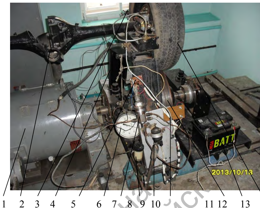
Рис. 2. Разработанное устройство управления торможением автомобиля на стенде: 1 – электродвигатель; 2 – мост; 3 – датчик скорости; 4 – рама; 5 – блок управления; 6 – манометр; 7 – модулятор; 8 – главный тормозной цилиндр; 9 – электромагнит; 10 – переключатели; 11 – маховик; 12 – АКБ; 13 – колесо
