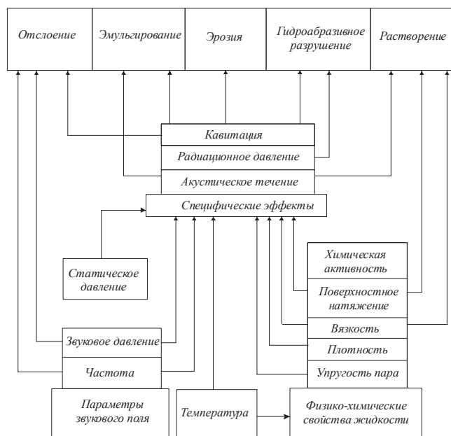
Рис. 1. Схема механизма ультразвуковой очистки
