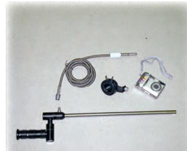
Одна из разработок лаборатории «Волоконно-оптическая диагностика» - эндоскоп для диагностики объектов авиационной техники с видеофиксацией изображения.
