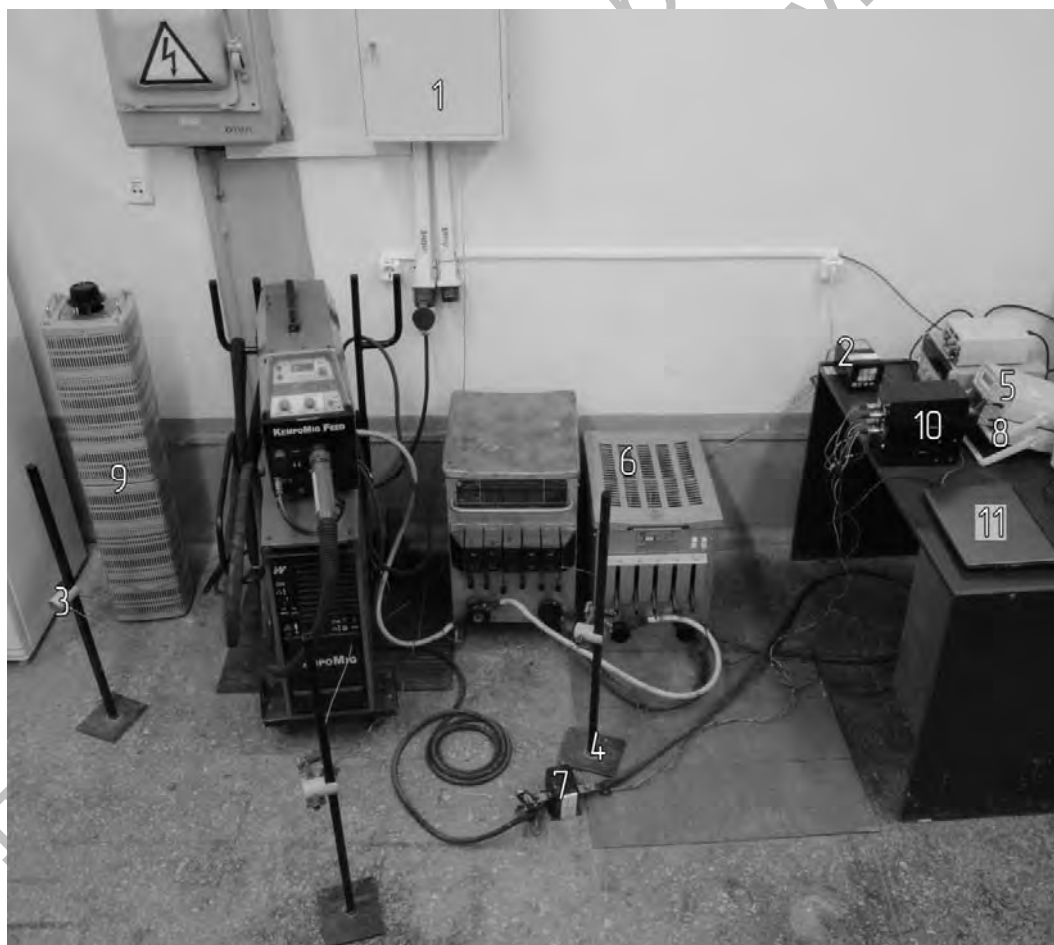
Рис. 2. Внешний вид установки: 1 – ЩС; 2 – измеритель-регулятор температуры; 3 – термопара; 4 – стойка; 5 – вольтметр; 6 – стандартная нагрузка; 7 – датчик тока; 8 – амперметр; 9 – ЛАТР; 10 – блок управления; 11 – ЭВМ
