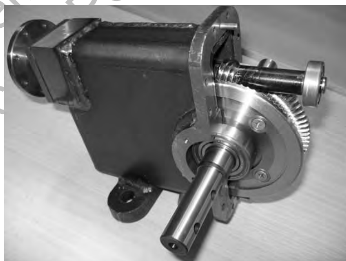
Рис. 4. Двухвенцовая червячная передача в составе редуктора культиватора
