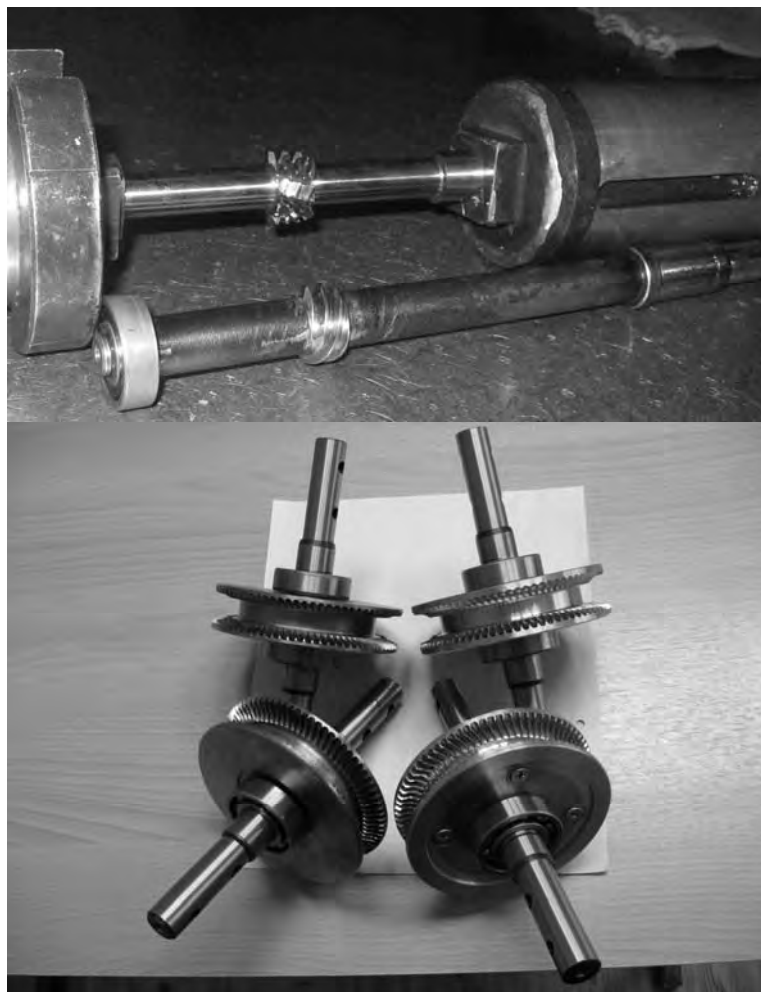
Рис. 3. Червяк передачи, фреза для нарезания двухвенцовых червячных колес, двухвенцовые червячные колеса в сборе, подготовленные для испытаний
