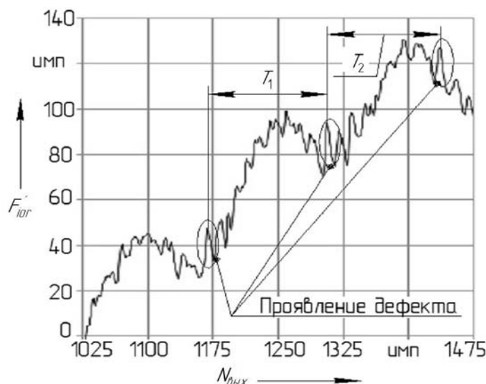
Рис. 10. Фрагмент графика изменения кинематической погрешности передачи
