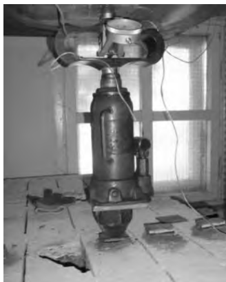
Рис. 1. Общий вид пресса П-125 (а) и схема испытания (б) верхних полок фрагмента плиты на продавливание: 1 – нижняя плита прессы; 2 – тяг; 3 – швеллер № 14; 4 – опытный образец; 5 – металлическая пластина (штамп); 6 – конусный металлический элемент; 7 – гидравлический домкрат; 8 – динамометр; 9 – верхняя плита прессы
