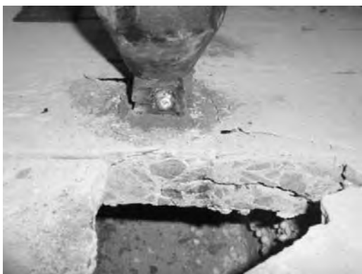
Рис. 3. Характер и схема разрушения полки типа II
