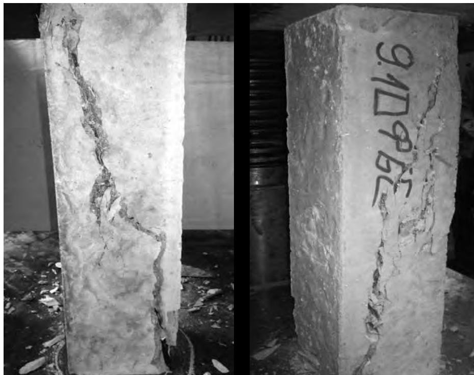
Рис. 5. Призмы с фибровым армированием после разрушения
