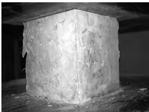
Рис. 2. Вид разрушения кубов с фиброй
