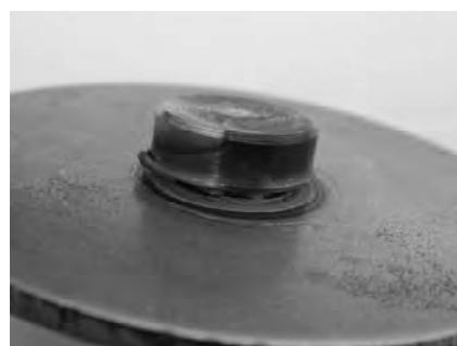
Рис. 14. Сварка пластины (сталь 08кп) с болтом без цинкового покрытия и резьбы (сталь 20)
