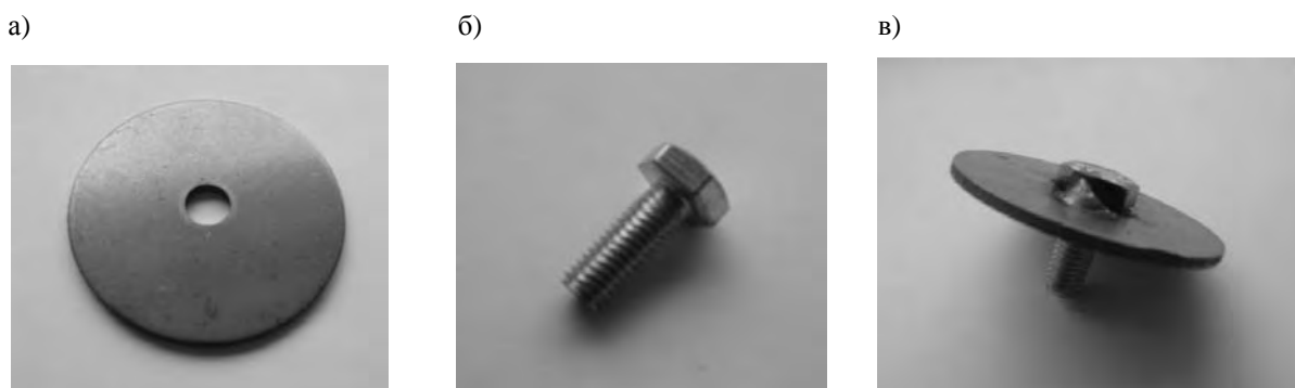
Рис. 1. Объект исследований – кронштейн лифта (в): а – пластина с отверстием; б – стандартный болт М10 × 24
