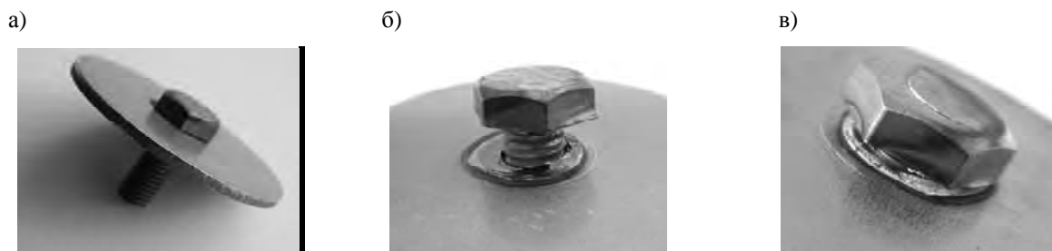
Рис. 15. Сварка стандартного болта М10 × 24 без цинкового покрытия (сталь 35) с пластиной (сталь 08кп) (а) и разрушенные образцы (б, в)
