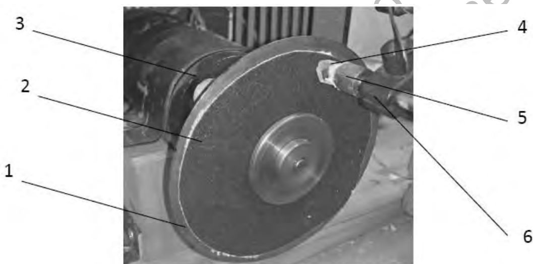
Рис. 8. Фотография зоны обработки при проведении экспериментов по истиранию поверхности образца
