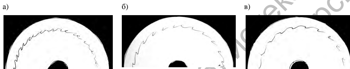
Рис. 7. Траектории движения точки, принадлежащей заготовке, на поверхности диска при различной частоте его вращения n и неизменной частоте возбуждения колебательной системы, равной 4 Гц: а – n = 8 \text{ мин}^{-1} ; б – n = 10 \text{ мин}^{-1} ; в – n = 12 \text{ мин}^{-1}
