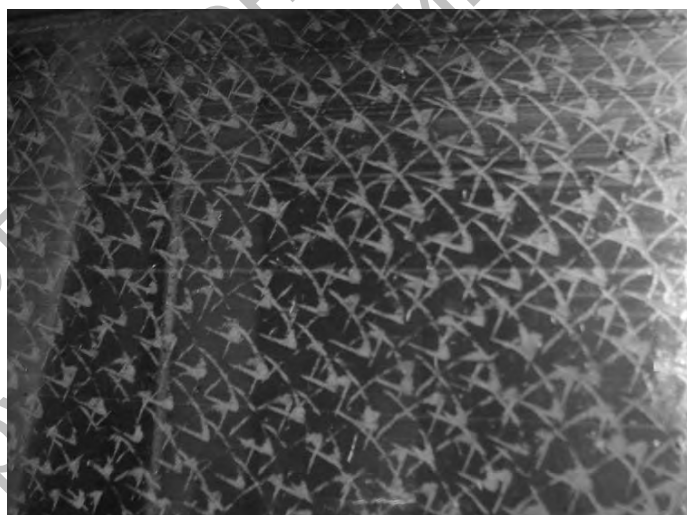
Рис. 2. Поверхность направляющих станин с твердым хромированием с последующим нанесением на упрочненной поверхности маслоудерживающей сетки
