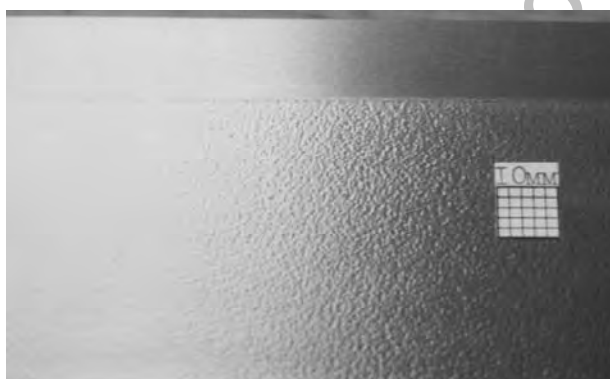
Рис. 3. Поверхность, обработанная упрочняющей импульсно-ударной ПВДО
