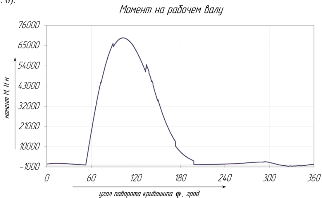
Рис. 6. График крутящего момента на рабочем валу
