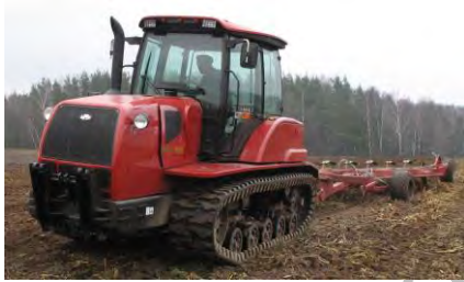
Рисунок 14. – Трактор «Беларус- 2103» с плугом Kverneland DC100
