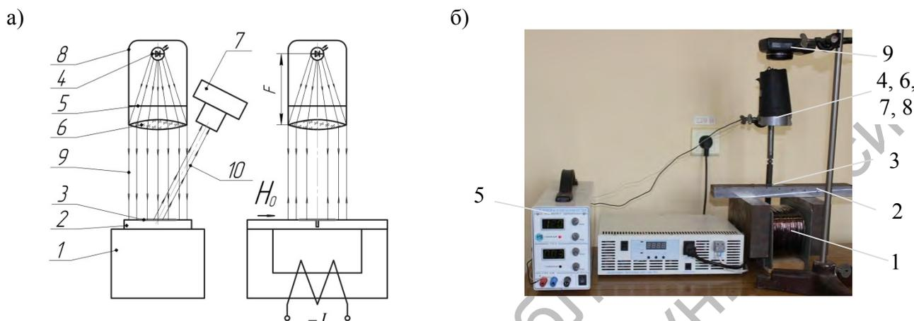
1 – электромагнит с П-образным сердечником, 2 – контролируемый образец, 3 – пленка, визуализирующая магнитные поля, 4 – источник света, 5 – источник питания; 6 – светофильтр, 7 – конденсор, 8 – корпус оптической системы; 9 – цифровой фотоаппарат; 10 – устройство обработки информации; 11 – падающее световое излучение; 12 – воспринимаемое излучение
