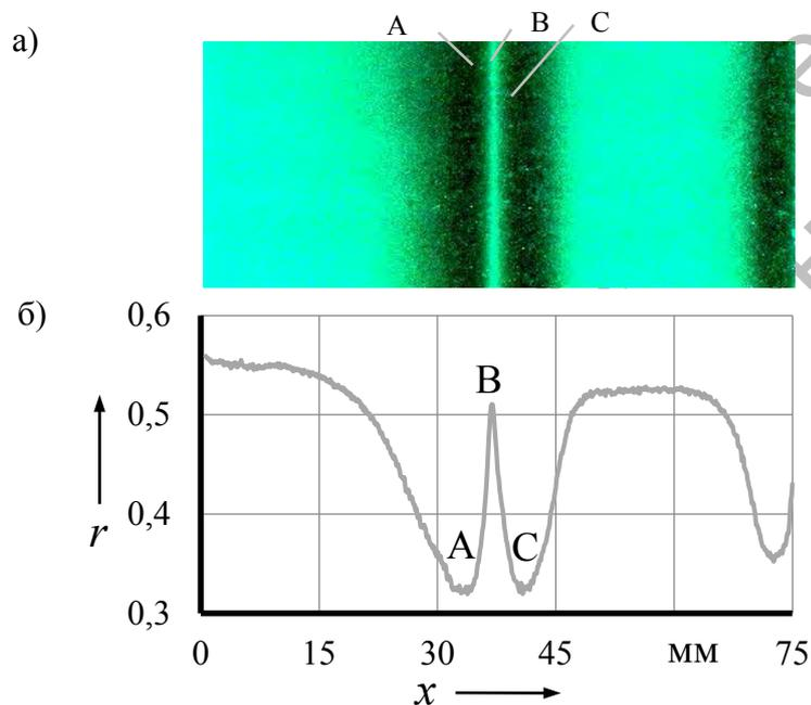
**Рисунок 3 – Изображение индикаторного рисунка дефекта (а) и соответствующей ему зависимости распределения коэффициента диффузного отражения света от пленки (б) от расстояния поперек плоского дефекта внутренней поверхности пластины: ширина дефекта – 1,5 мм, глубина – 3 мм**
