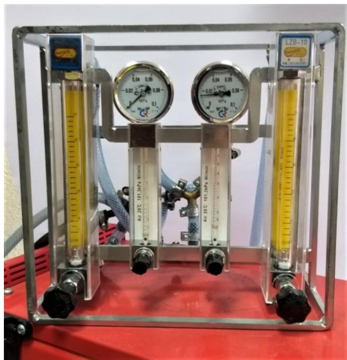
Рисунок 1 – Установка для смешивания трехкомпонентной защитной газовой среды
