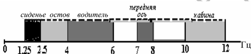
Рисунок 2 – Распределение частот колебаний по элементам конструкции колёсного трактора
