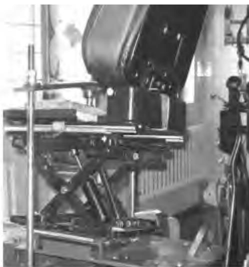
**Рисунок 14 – Вибростенд испытаний сиденья 95-6800010**
