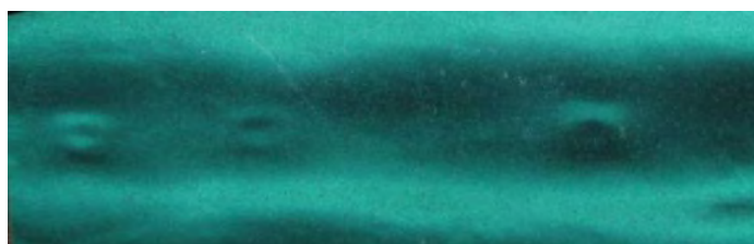
Рис. 5. Индикаторный рисунок шлаковых включений в образце
