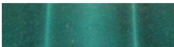
Рис. 8. Индикаторный рисунок двух внутренних цилиндрических несплошностей диаметром 2 мм в стальной пластине толщиной 25 мм
