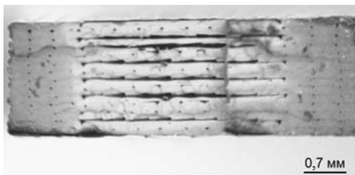
Рис. 1. Фотография поверхности разлома образца А4 (увеличение \times 40 )
