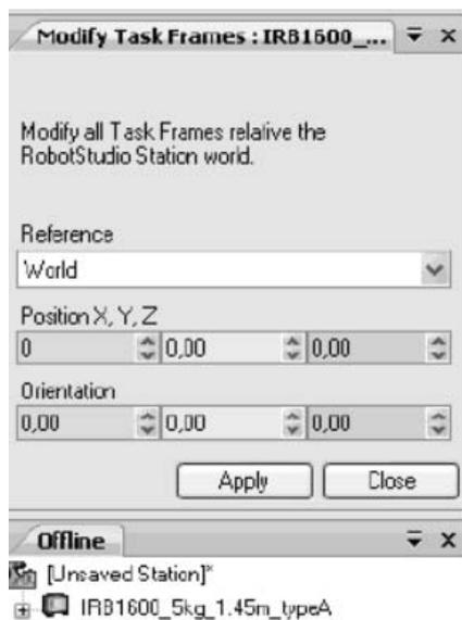
Рисунок 1.14 – Окно для изменения системы координат и положения робота
