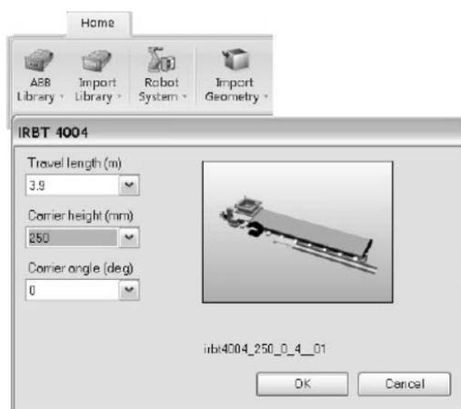
Рисунок 1.16 – Вставка цифрового библиотечного прототипа платформы робота
