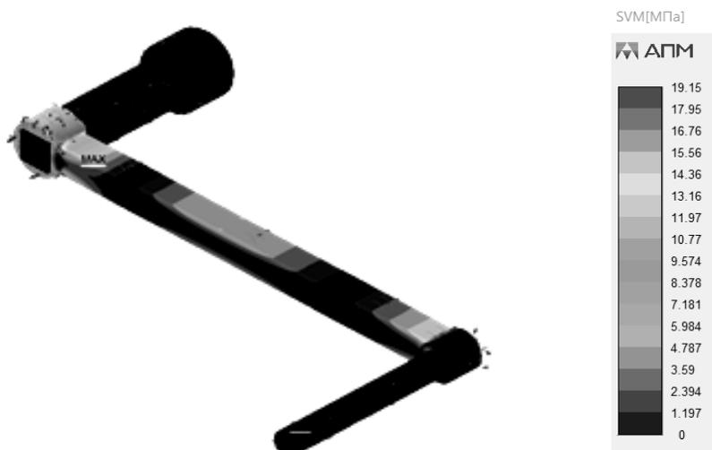
Рис. 3. Результаты прочностного расчета солнечного колеса с ручкой на напряжение в программе КОМПАС-3D
